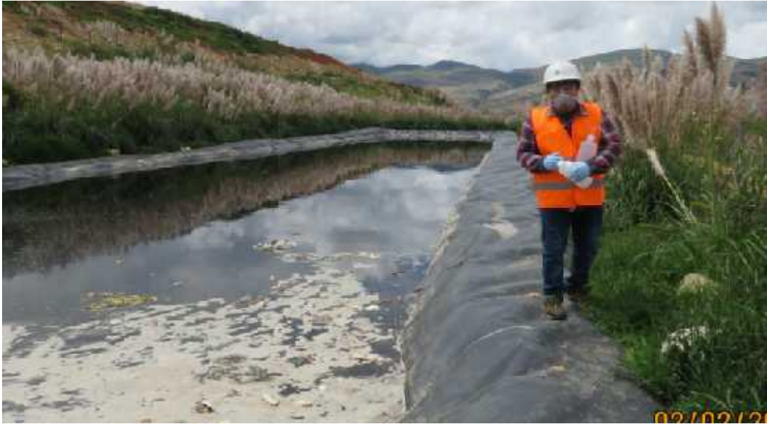
Figura 31. Toma de muestra en la Poza 2, se evidencia al encargado del muestreo, tomar el parámetro de DBO_5 el cual no es preservado.
