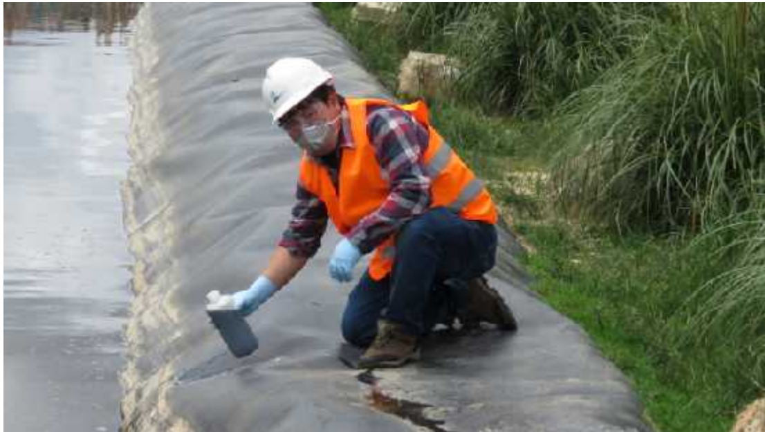
Figura 33. Se realiza la toma de muestra del parámetro pH, con la finalidad de evidenciar el proceso de neutralización que realiza la municipalidad a sus pozas.
