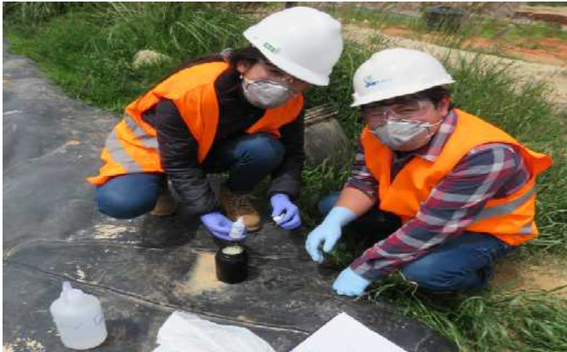
Figura 34. Se evidencia el momento donde se realiza la preservación de la muestra de DQO con ácido sulfúrico el cual se da en todas las muestras de este parámetro.
