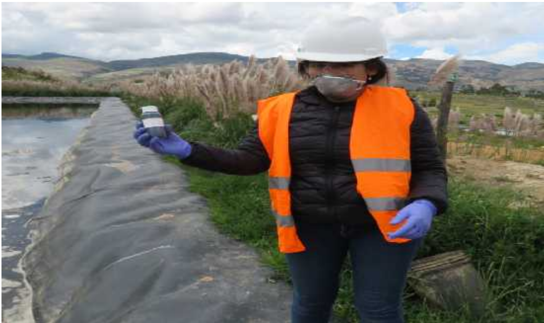
Figura 32. Toma de muestra en la Poza 3, se realiza el recojo de muestra de DQO , cumpliendo con los estándares de calidad para mantener sus características reales y así llegar en óptimas condiciones al laboratorio.
