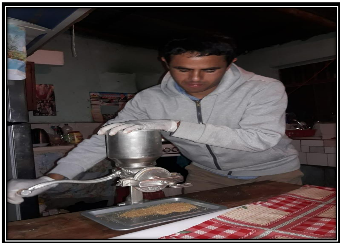
Figura 45: Foto 10 Proceso de molienda de las cáscaras de mandarina Fuente: Elaboración propia
